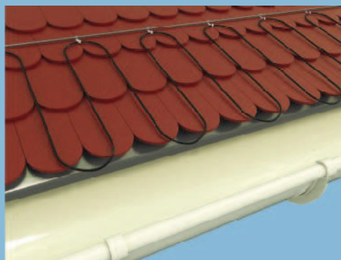
Przykład ogrzewania krawędzi dachu
